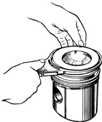
Рис. 80. Снятие и надевание поршневых колец на поршень
