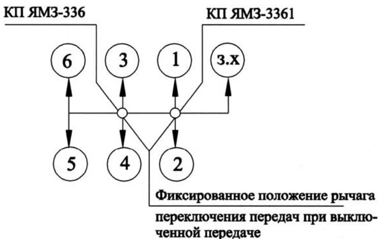
Рис. 111. Схема переключения передач КПП.
