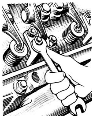
Рис. 74.Отвертывание гайки скобы крепления форсунки
